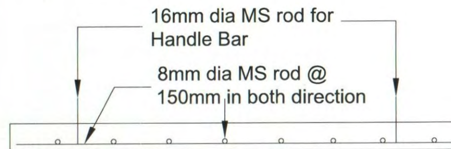
Slab Section A-A
